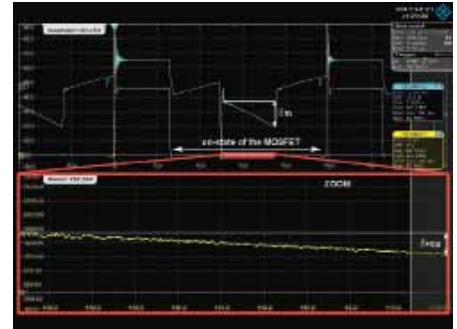
Figur 9. R_{DS(on)} beräknas differentiellt baserat på \Delta u_{DS} och \Delta i_D .
