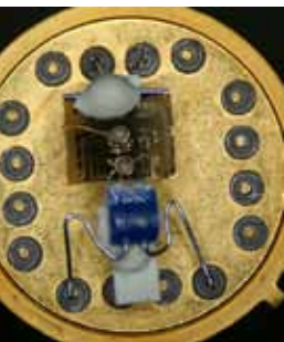
En prototyp av en gassensor av SenSiC AB som baseras på grafen på kiselkarbid.
