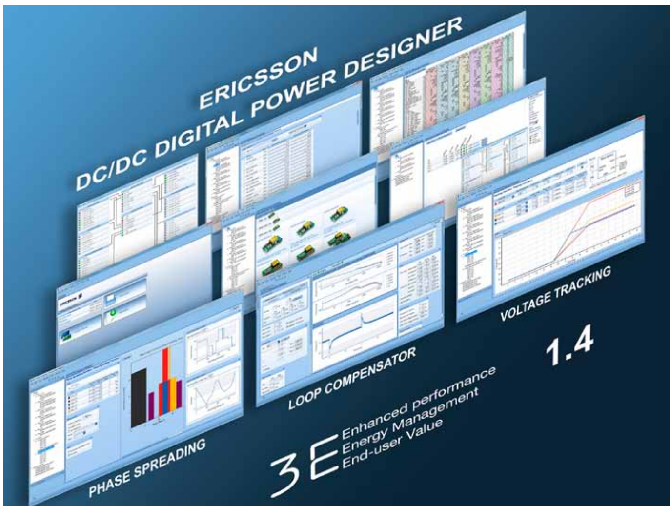
Fig 1 Ericsson Power Designer innehåller en uppsättning verktyg som gör det enklare att konfigurera och optimera kraftsystemet.
