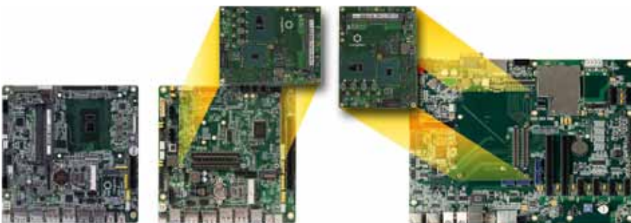
Beroende på designkoncept och antal robotar som ska tillverkas kan man välja mellan moderkort som följer Mini-ITX, standardiserade bärarkort med datormoduler, skräddarsydda bärarkort med datormoduler eller fullt ut skräddarsydda kort. Congatec kan leverera alla fyra varianterna.
