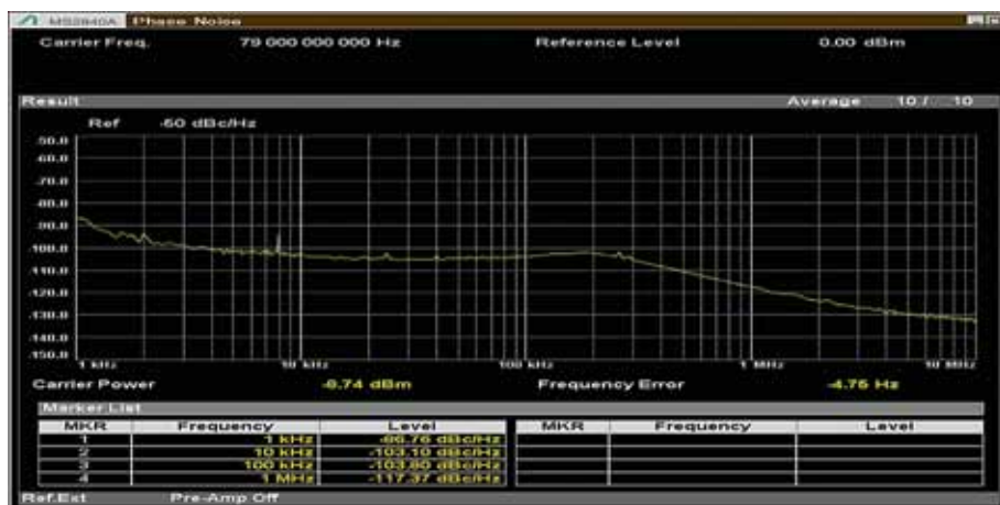
När tids- och frekvenskillnaden mellan en utsänd och mottagen signal är liten och spektrumanalysatorns fasbrusprestanda är dålig kan signalerna inte separeras eftersom den mottagna signalen kan skymmas av fasbruset hos den utsända signalen.
