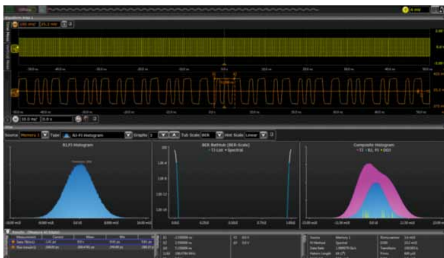
Figur 1. Moderna oscilloskop har analysfunktioner som tidigare bara kunde göras av datorer.
