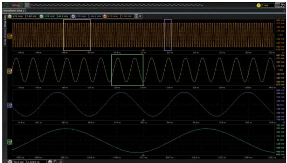
Figur 7. Genom mätningar inom avgränsningar kan användarna nu samtidigt se på flera exempel på en vågform.
